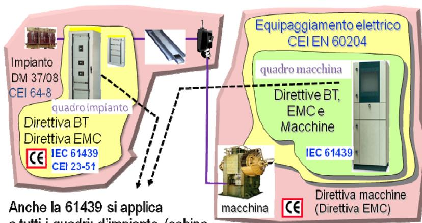
Anche la 61439 si applica a tutti i quadri: d'impianto (cabina, distribuzione, ecc) e di macchina (automazione, processo, ecc)
