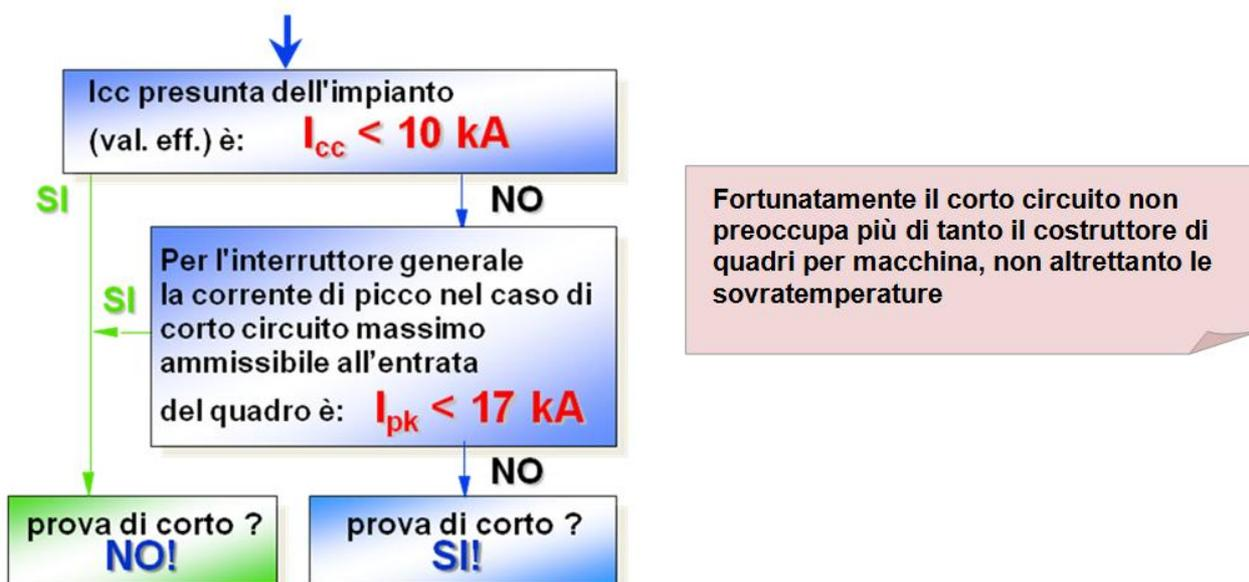
Operativamente da anni i quadri macchina sono realizzati inizialmente sulle indicazioni della norma macchine e integrate poi dalle prescrizioni relative alla tenuta delle sovratemperature e del corto circuito previste nella norma generale dei quadri (prima CEI EN 60439-1 ora 61439-1).
