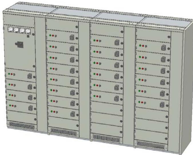
Correnti d'impiego e relative correnti di corto circuito sono più basse dei quadri principali, ma hanno comunque una notevole importanza nell'impianto di distribuzione; proprio per questo, esiste la versione di MCC realizzata con cassette estraibili per facilitare gli interventi di manutenzione e sostituzione delle apparecchiature nei quadri che comandano gli impianti industriali a ciclo continuo. Questa peculiarità garantisce rapidità d'intervento con massime garanzie di continuità di servizio.
